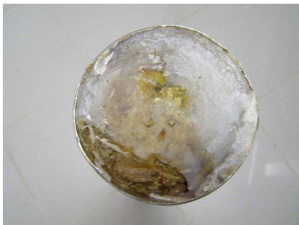
Figura 2.2. Estremità inferiore a) e superiore b) del campione indisturbato S7 C.I.2 prelevato a profondità di 15.00-15.60 m da p.c.; Estremità inferiore c) e superiore d) del campione indisturbato S13 C.I.2 prelevato a profondità di 23.00-23.50 m da p.c.; Estremità inferiore e) e superiore f) del campione indisturbato S1bis C.I.1 prelevato a profondità di 5.40-5.90 m da p.c. Le estremità dei campioni appaiono non correttamente paraffinate e in alcuni casi i bordi delle fustelle sono visibilmente deformati.
