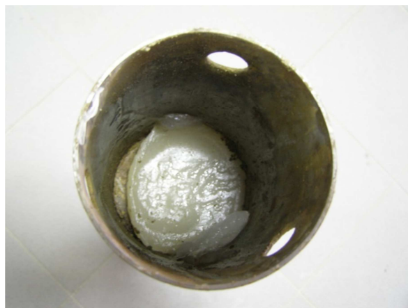
Figura 2.2. Estremità inferiore a) e superiore b) del campione indisturbato S7 C.I.2 prelevato a profondità di 15.00-15.60 m da p.c.; Estremità inferiore c) e superiore d) del campione indisturbato S13 C.I.2 prelevato a profondità di 23.00-23.50 m da p.c.; Estremità inferiore e) e superiore f) del campione indisturbato S1bis C.I.1 prelevato a profondità di 5.40-5.90 m da p.c. Le estremità dei campioni appaiono non correttamente paraffinate e in alcuni casi i bordi delle fustelle sono visibilmente deformati.
