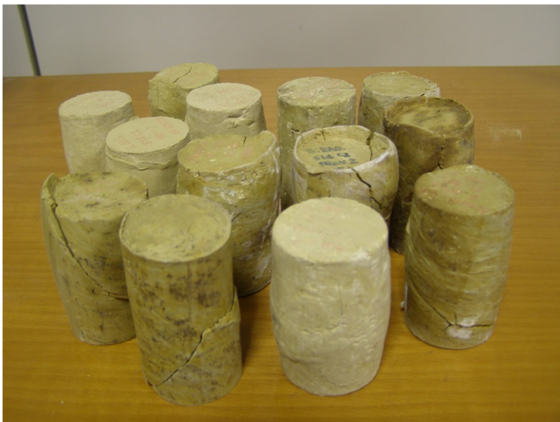
Figura 4.1. Provini triassiali portati a rottura.
